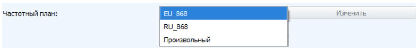
Счётчик импульсов поддерживает следующие частотные планы:
