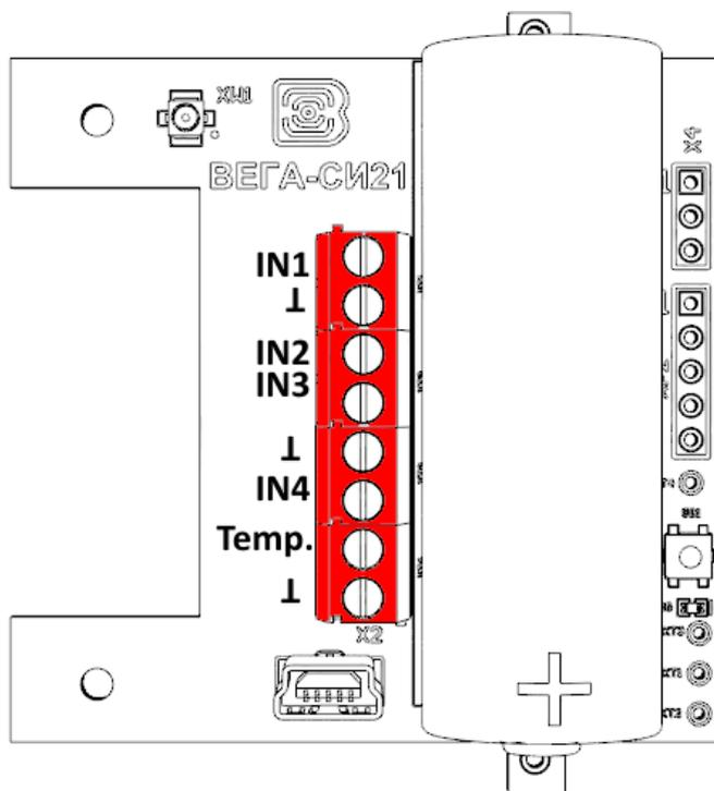
Счетчик импульсов имеет 4 импульсных входа и позволяет подключать цепи со следующими типами замыкающих контактов:
